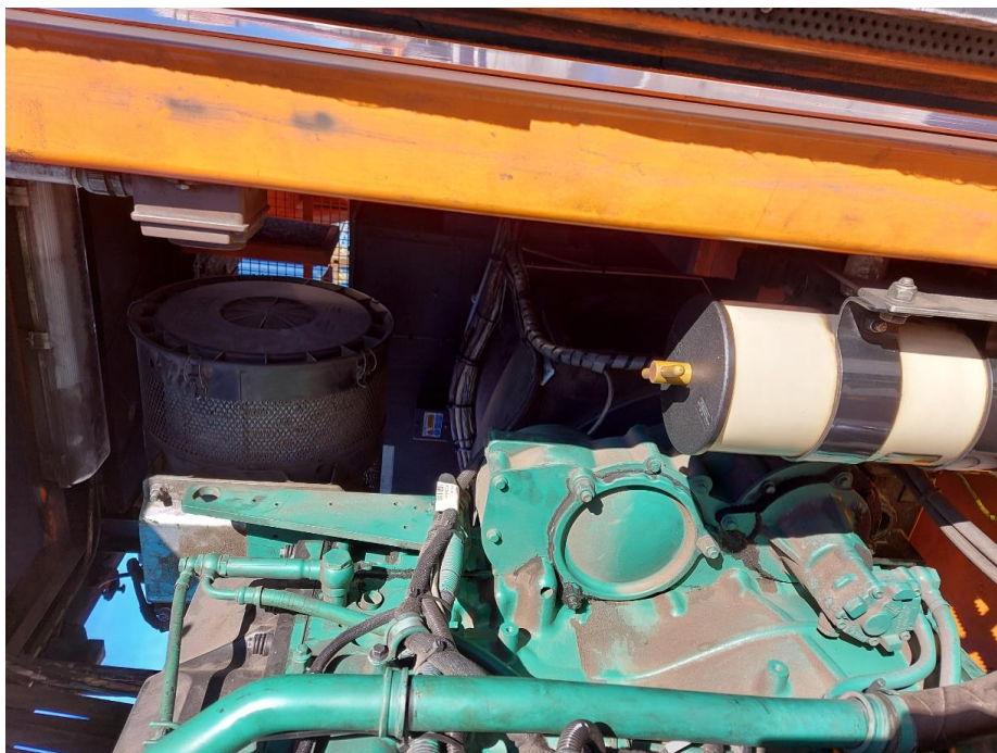
Slika 2: Pogonski agregat na RTG dvigalu TS 34
